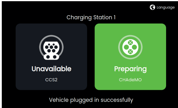
Image 14 : Préparation de CHAdeMO - connecteur branché
