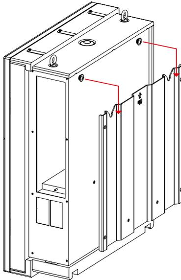
Imagem 9: Wall Box deslizando na placa de montagem
