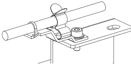
Imagem 23: LIGAÇÃO DO CABO ETHERNET À TERRA
