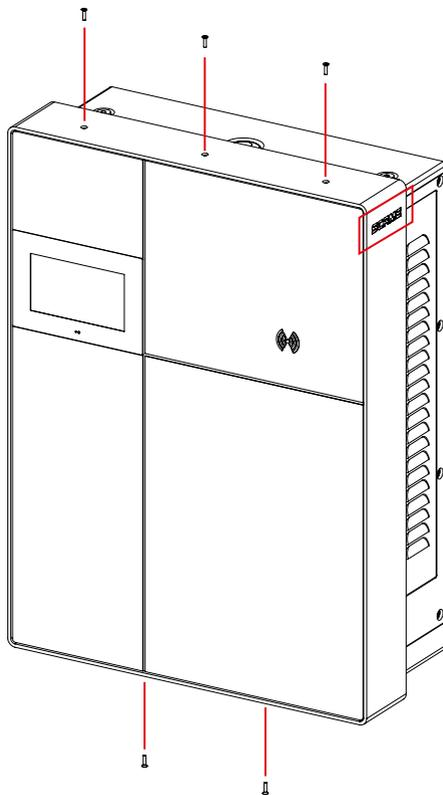
Imagem 11: Instalação da armação metálica
