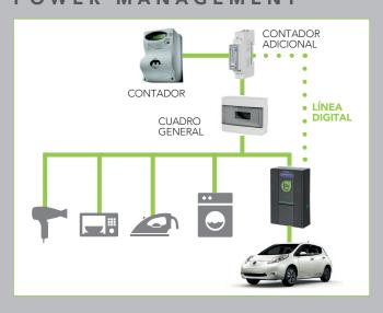
El Wall Box BE-W en versión POWER MANAGEMENT es una estación de recarga de pared conforme al "MODO 3", según la Normativa Internacional IEC/EN 61851-1. Fabricada en tecnopolímero libre de halógenos, se caracteriza por un acabado Dual Feel Sensitive y por un diseño que exalta líneas limpias y esenciales.
